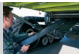
Geteilter, nach vorn herausziehbarer Vorbereitungsboden.
