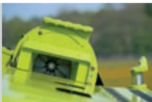
Staubabsaugung am Einzugskanal für freie Sicht.
